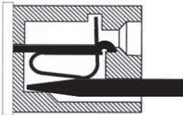
③ドライバを保持させたまま、電線挿入穴に電線あるいは棒端子を挿入します。
