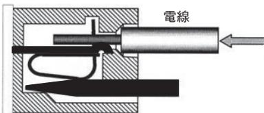
④ドライバを引き抜くことで、電線はスプリングにより固定され接続が完了します。
