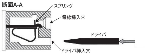
②ドライバをソケット内部のストッパに当たるまで押し込みます。この状態で、電線挿入穴の奥にあるスプリングが完全に開口します。ドライバは保持されるため、手を離しても抜けません。
