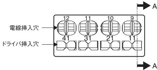
①ソケットのドライバ挿入穴に、ドライバを差し込みます。
