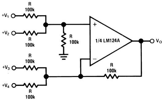
ここで、 $V_O = V_1 + V_2 - V_3 - V_4$
