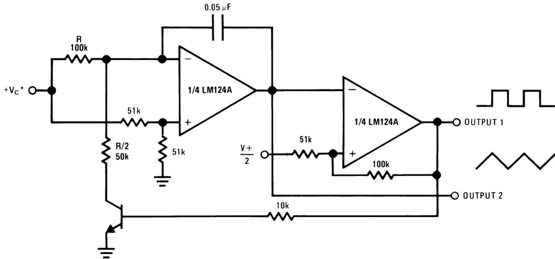
\* 幅広い制御電圧範囲:  $0 V_{DC} < V_C < 2(V^+ - 1.5 V_{DC})$
