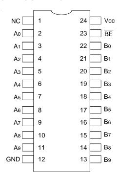
SOIC/ QSOP/ TSSOP TOP VIEW
