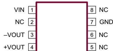
8-Lead SOIC (Narrow Body) (LG)
