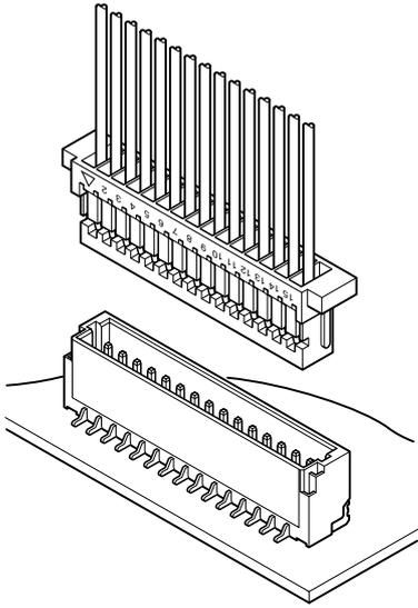
基板対電線用最小の1.0mmピッチで初の圧着方式を採用。ハウジングランス方式の採用で作業性が高く、コンタクトは、集中接点方式で優れた接触信頼性を発揮します。
