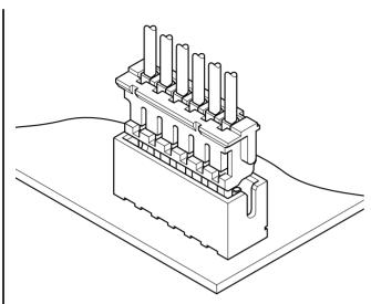
圧着タイプで実装高さ5.6mm、厚さ3.5mmの小型化を 実現しました。ハウジングランス方式の採用で挿入作業性が 高く、コンタクトはピンとの接触部中央にディンプルを設け、 安定した接触性能を発揮します。
