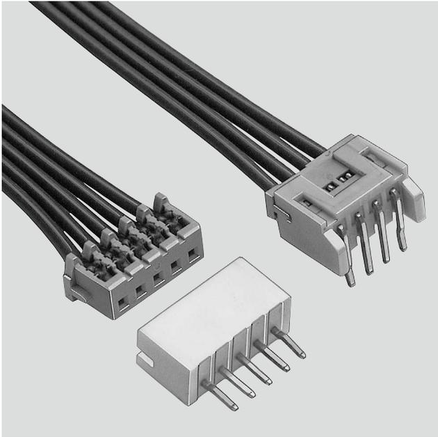
UL1007電線に対応した2.0mmピッチ圧接コネクタです。電気用品安全法に規定される機器等の内部配線に使用されるUL1007電線の接続を2.0mmピッチ圧接コネクタで可能にしました。実装高さ6.9mm、厚さ4.8mm(トップ型)の低背設計。VTR、ビデオカメラ等幅広い機器にご利用いただけます。
