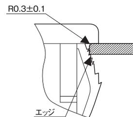
パネル取り付け穴表面には上記に指定するR加工を施すか、抜きRがパネルの表面となるようにしてご使用ください。
