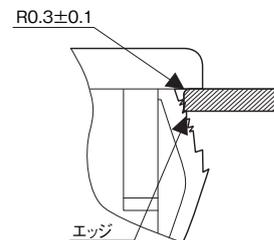
パネル取り付け穴表面には上記に指定するR加工を施すか、抜きRがパネルの表面となるようにしてご使用ください。
